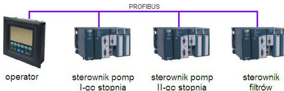
Rys. 2 Rozproszony system sterowania stacją uzdatniania wody (SUW)
